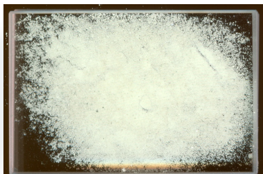
Порошок наночастиц серы, средний размер 55 нм
