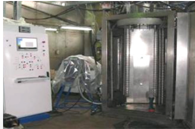
Опытный образец установки для нанесения новых многофункциональных нано-покрытий
