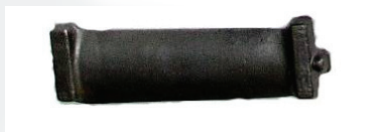
Опытная лопатка газотурбинного двигателя из наноструктурного сплава VT-6 (разработано совместно с УМПО)
