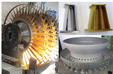
Детали и узлы, на которых применяется нанесение защитных покрытий, в том числе наноструктурированное покрытие
