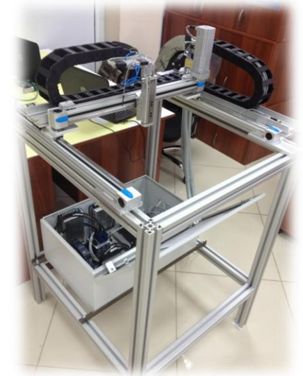
Установка для селективного нанесения влагозащитных покрытий
