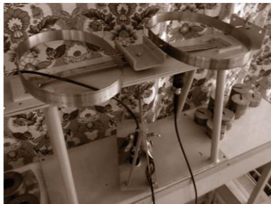
Рисунок 10. Установка датчиков на виброизолятор
