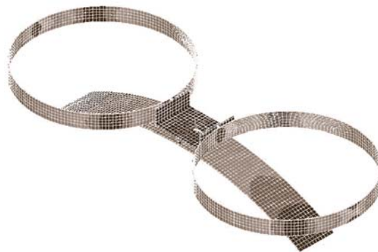
Красная часть – напряженные точки конструкции; зеленая часть – напряженные точки конструкции; Рисунок 3. Модель виброопоры в Ansys
