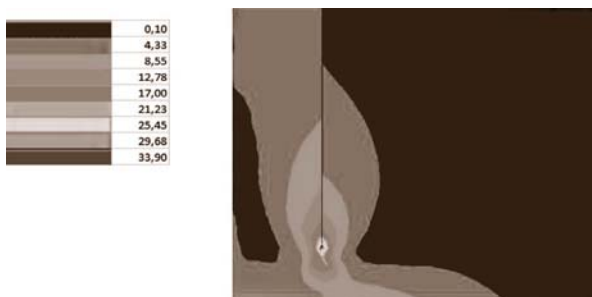
Рисунок 7. Распределение напряжений в соединении выполненной контактной сваркой, МПа
