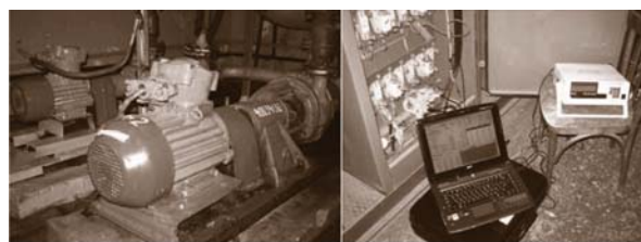
а) структурная схема; б) внешний вид Рисунок 1. Экспериментальная установка для исследования центробежных насосов с электроприводом
