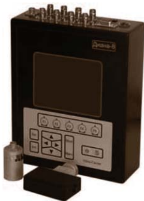
Рисунок 10. Восьмиканальный синхронный регистратор-анализатор вибросигналов «Диана-8»
